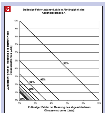
6 Maximal zulässiger Messfehler für abgeschiedenen und austretenden Ölmassestrom bei unterschiedlichen Abscheidegraden
