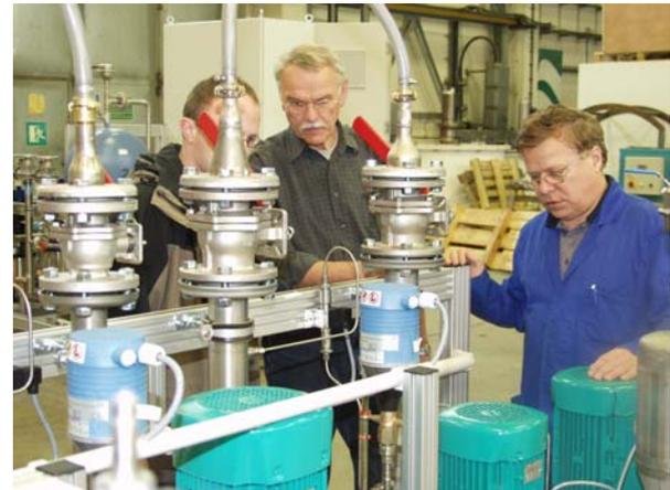
ILK-Mitarbeiter bei der Erprobung des Prototyps einer Heiz- und Kühlanlage
