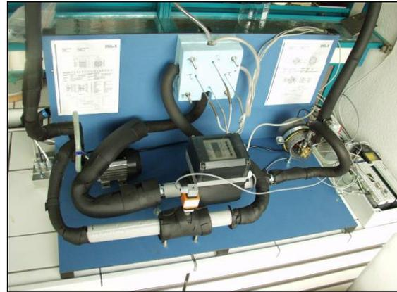
Bild 2: Prüfstand für Mikrowärmeübertrager
