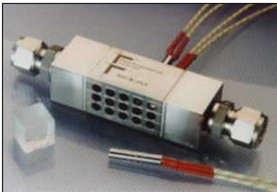
Bild 1: Mikrodurchlauferhitzer Typ 960-K-5.2 (IMVT Karlsruhe) für 15 Heizpatronen mit einer max. Gesamtleistung von 3 kW [Bild: Forschungszentrum Karlsruhe]
