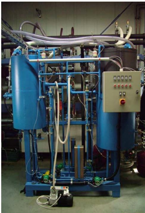
Bild 2: Wasser-/Lithiumbromid-Resorptions-Versuchsanlage
