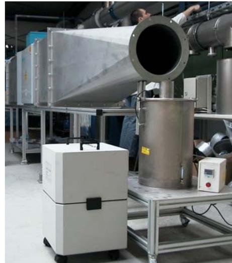
Versuchsstand mit Aerosoldosierung
