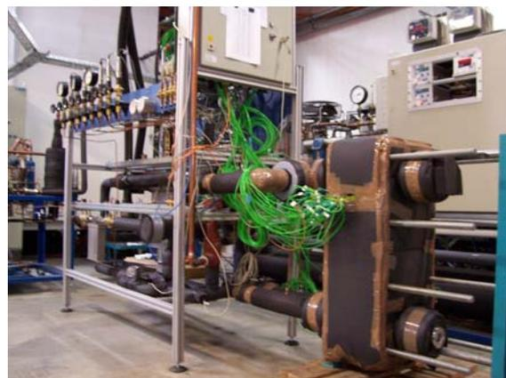
Umfangreiche Messungen wurden an diesem Versuchsstand durchgeführt, u. a. auch an porösen Füllkörpern, die zur Vergleichmäßigung der Beaufschlagung mit Kältemittel gedacht waren.
