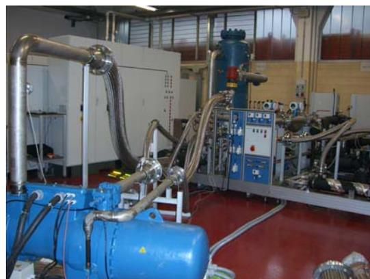
Bild: Verdichterleistungsprüfstand für Schraubenverdichter Frascold 900 kW
