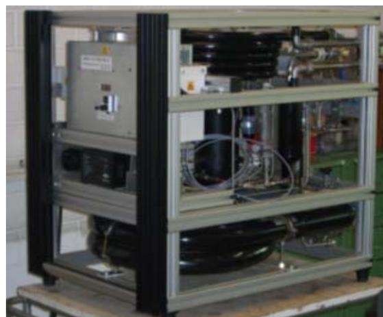
Bild: CO<sub>2</sub>-Wärmepumpe in Modulbauweise
