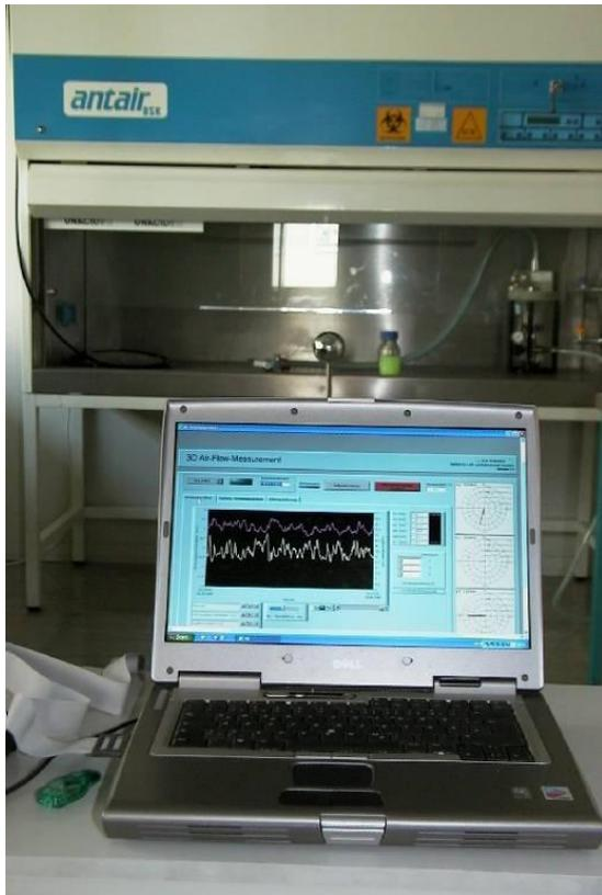
Bild: Sicherheitswerkbank mit Strömungsmesstechnik
