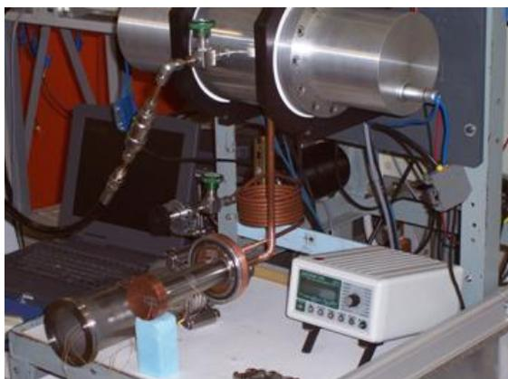
Bild: Split-Pulse-Tube-Kryokühler (Funktionsmuster)
