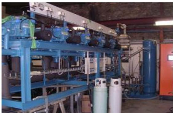
Bild: Kompressionskälteanlage für CMS
