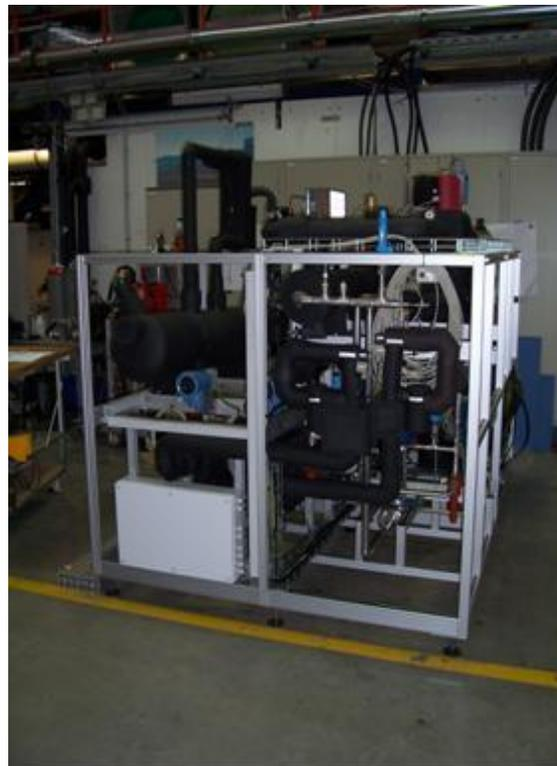
Bild: Prüfstand zur Lastsimulation von CO<sub>2</sub>-Boostern
