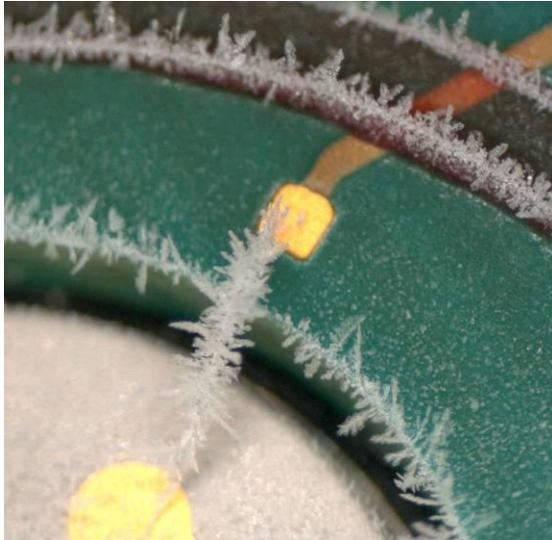
Bild 3: Eisbildung am Bonddraht
