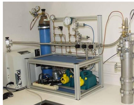
Bild 2: Vakuumhauben-Prüfstand
