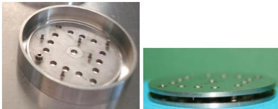
Bild: Haltevorrichtung (IGEL) offen in einer Metalldose (links) und im geschlossenen Zustand (rechts)
