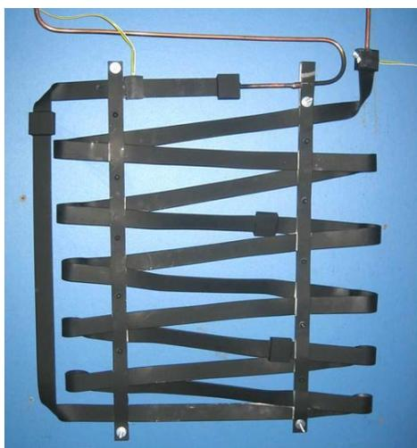
Bild: Prototyp für einen flächenhaft durchströmten Rückwandverflüssiger
