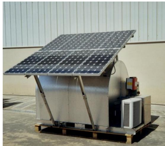
Bild: Solarer Wasserkühler
