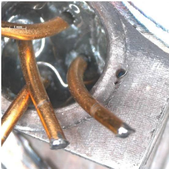
Bild 1: Ungleichmäßige Schweißnaht
