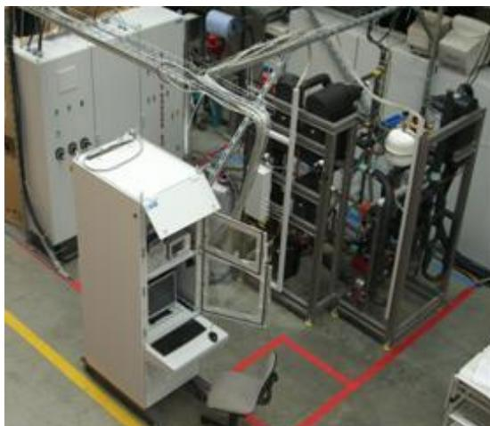
Bild: Verdichterleistungsprüfstand 125 kW
