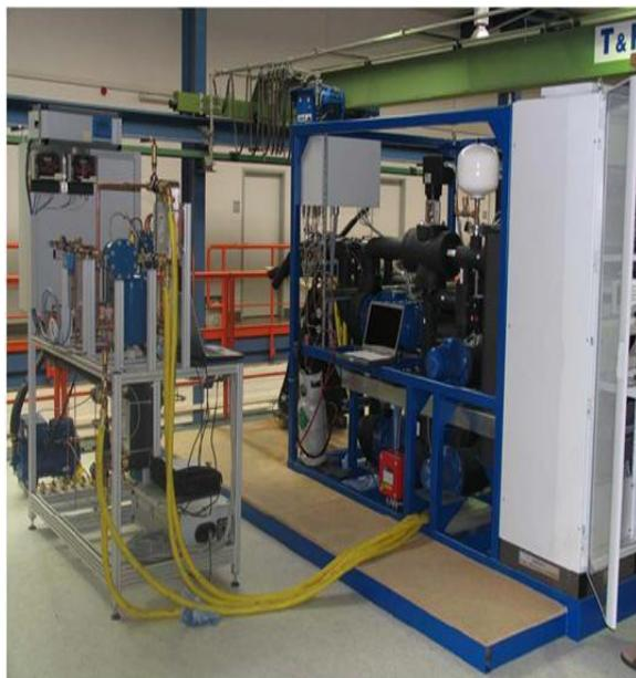
Bild: Messprüfstand für Bestimmung des Abscheidegrades von kältetechnischen Ölabscheidern (mit Sole- und Kühlwasseranschlüssen)
