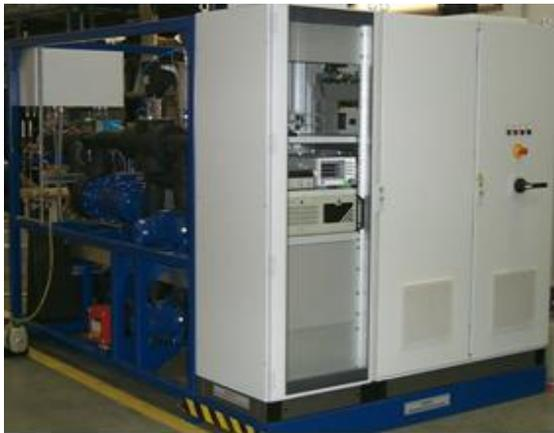
Bild: Prüfstand Sole-Wasser-Wärmepumpen
