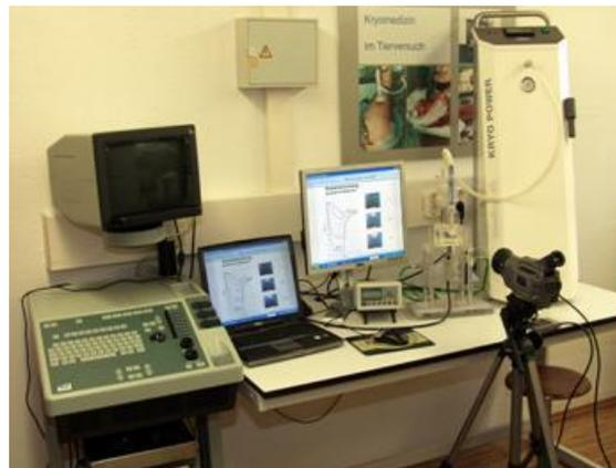
Bild: Messanordnung zur Durchführung der Prüfungen und Tests kryochirurgischer Geräte
