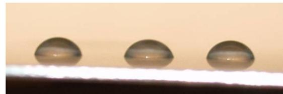
Bild 4: Hydrophobere Oberfläche
