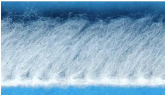
Bild 3: Aufbau des Polfaservlieswirkstoffes Hycoknit®
