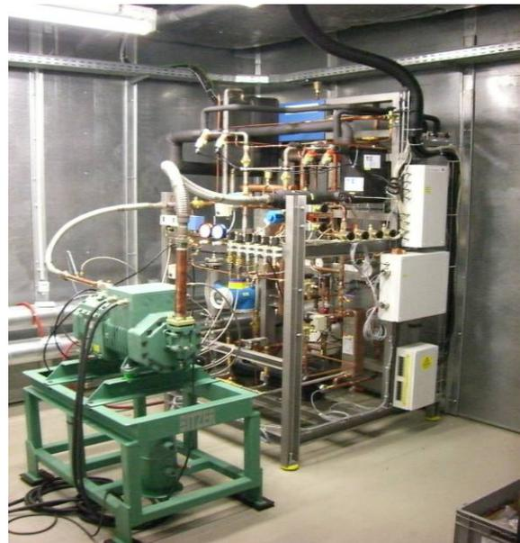
Bild 2: Verdichter-Leistungsprüfstand in Schkeuditz
