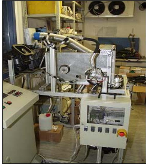
Bild 1: Prüfstand für Messungen an PKW-Klimaanlagen
