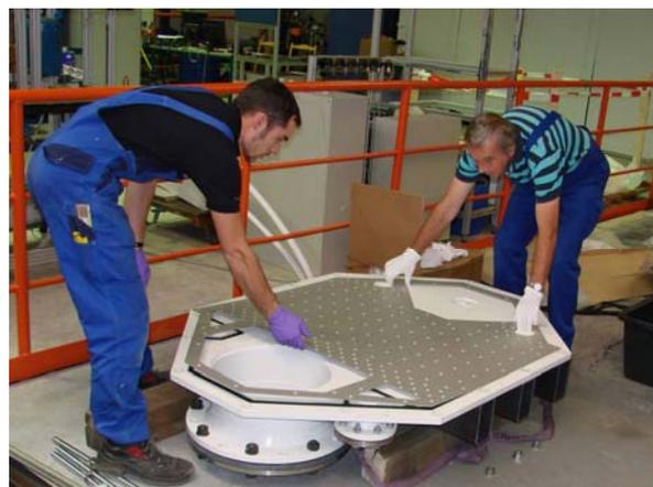
Bild 1: Segment des Plattenwärmeübertragers bei der Montage
