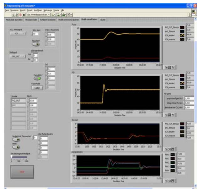
Bild 1: Sprungantworten eines Fuzzy- bzw. PID-Reglers
