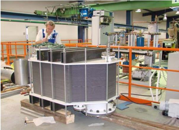
Bild 2: Montage Platten-Verdampfer-Kondensator für Meerwasserentsalzung
