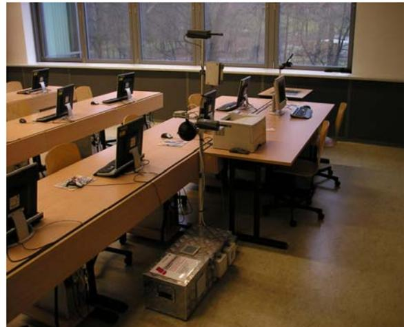
Bild 2: Behaglichkeitsmessung in einem Computerkabinett
