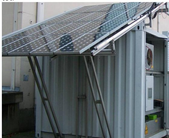
Bild 2: Test beim Einsatz in einem autarken Kühlcontainer
