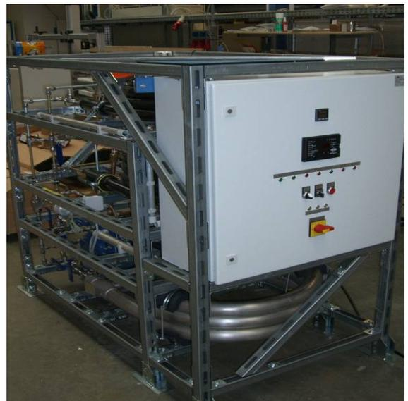
Bild 3: Prototyp der CO<sub>2</sub>-Wärmepumpe
