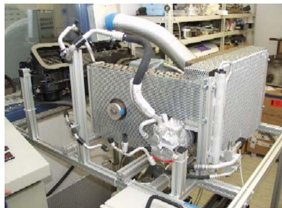
Bild 2: Dichtheitsprüfstand für PKW-Klimaanlagen
