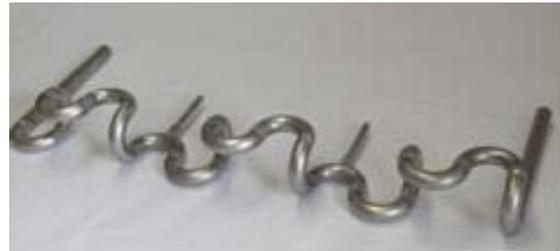
Bild 1: Alternativ gewickelte Rohrschlange, bestehend aus 180°-Rohrbogen
