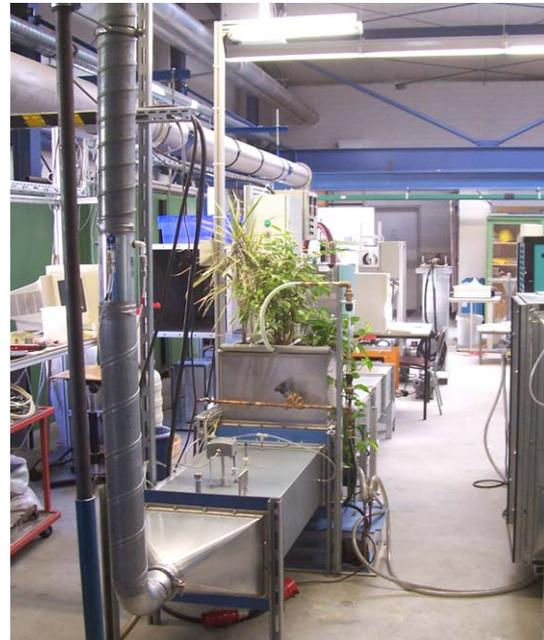
Bild 2: Prüfstand Airflowersystem als Funktionsmuster
