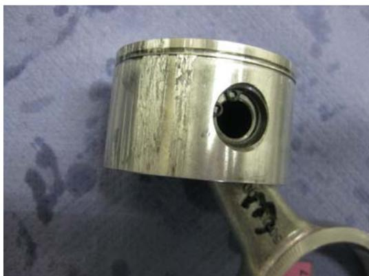
Bild 2: Verdichterkolben mit Schaden
