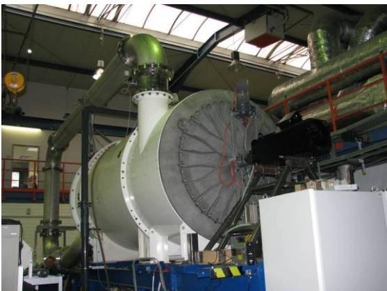
Bild 2: Versuchsverdichter auf dem ILK-Verdichterprüfstand.
