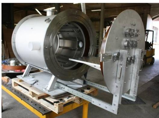
Bild 1: Materialprüfkammer mit geöffneter Tür und Probenstisch
