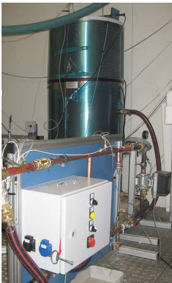
Bild 1:: Wärmepumpe im Prüffeld
