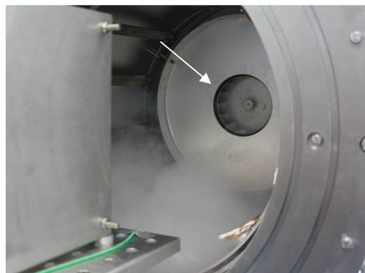
Bild 2: Lüfter in der Kammer zur Prozessgasumwälzung
