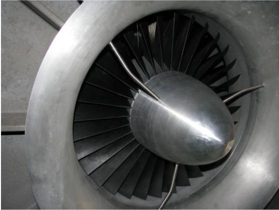
Bild 1: Blick auf die Saugseite eines Wasserdampf-Turboverdichters
