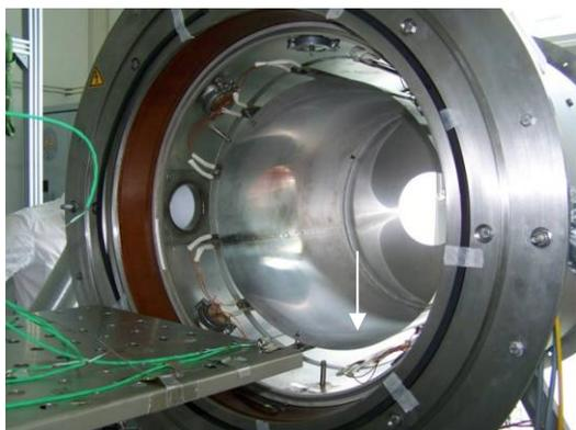
Bild 3: Innenansicht der Kammer mit Leitblech (radial angeordnet)
