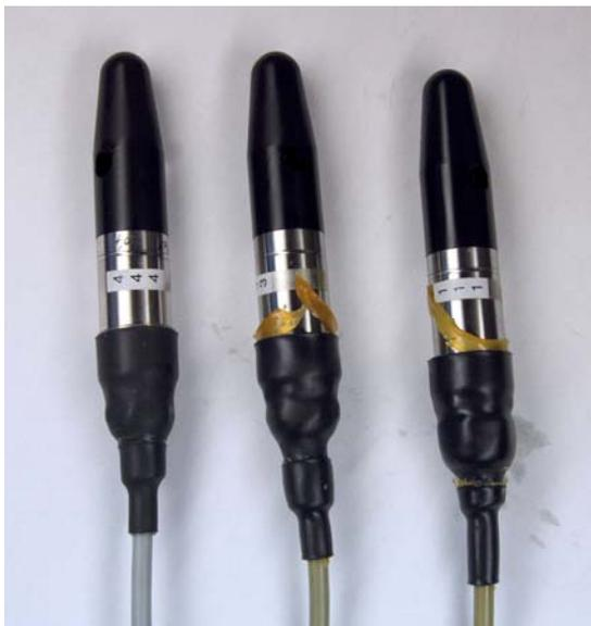
Bild 2: Tauchsonden nach Biodieselbelastung
