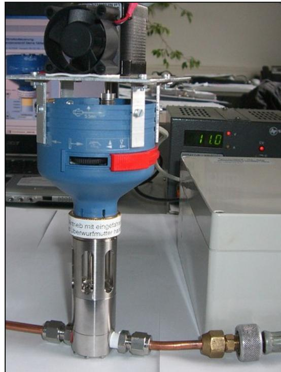
Bild 2: Expansionsventil mit Schrittmotor
