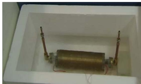
Bild 2: Kryoflüssigkeitspumpe in Flüssigstickstoff während der Erprobung
