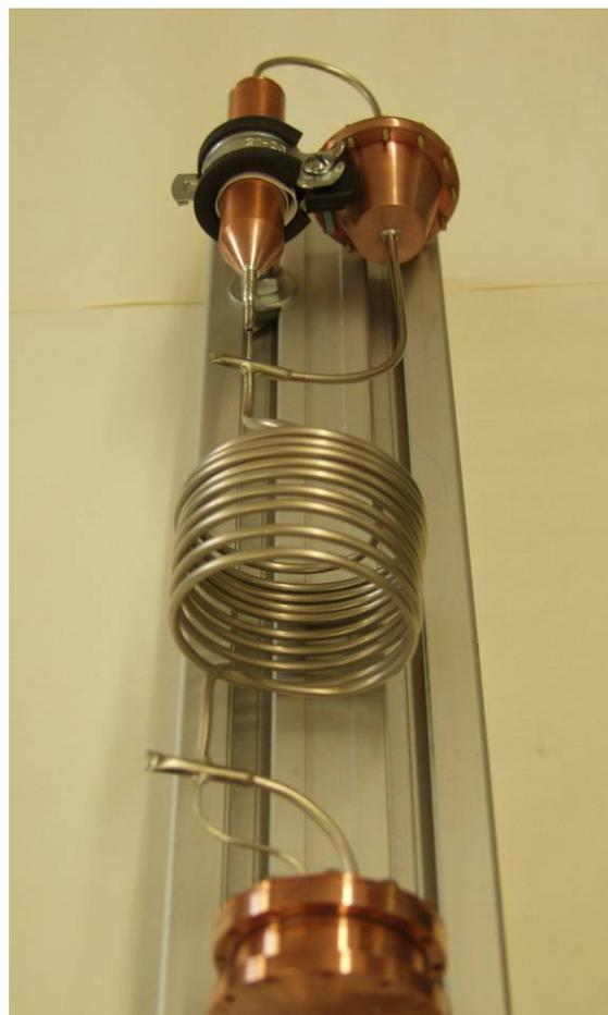
Bild 2:  $^3\text{He}$ - $^4\text{He}$ -Kreislauf mit Mischkammer (unten), Wärmetauscher (Mitte), Destille (oben rechts) und Kondensator (oben links, in provisorischer Halterung für Dichtstests)
