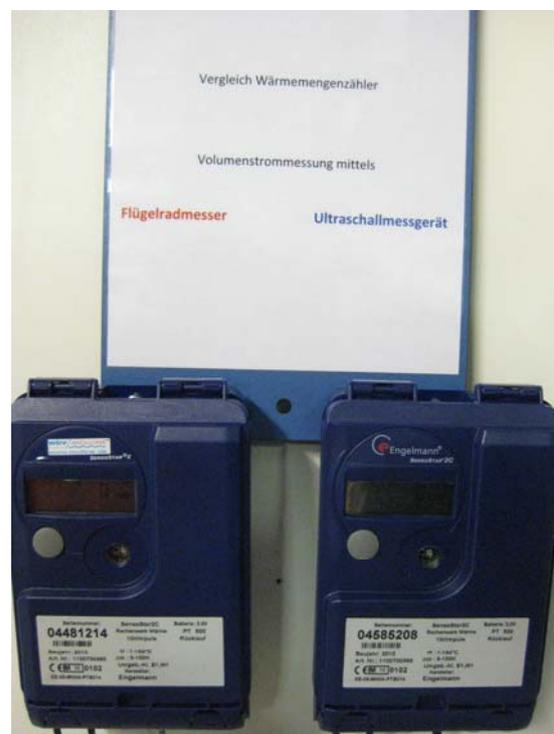
Bild 1: Wärmemengenzähler
