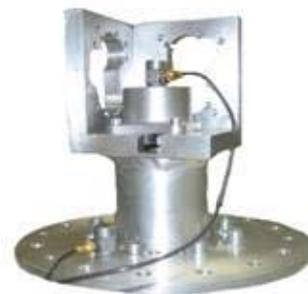
Bild 1: Schwingungsaufnahme Drucktransmitter
