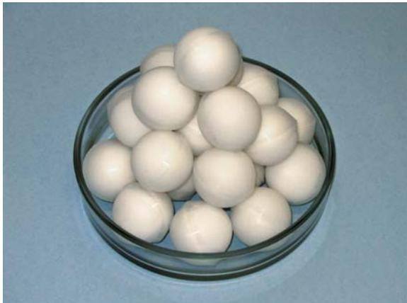
Bild 1: Silikongekapselte HT-PCM-Wärmespeicherkugeln
