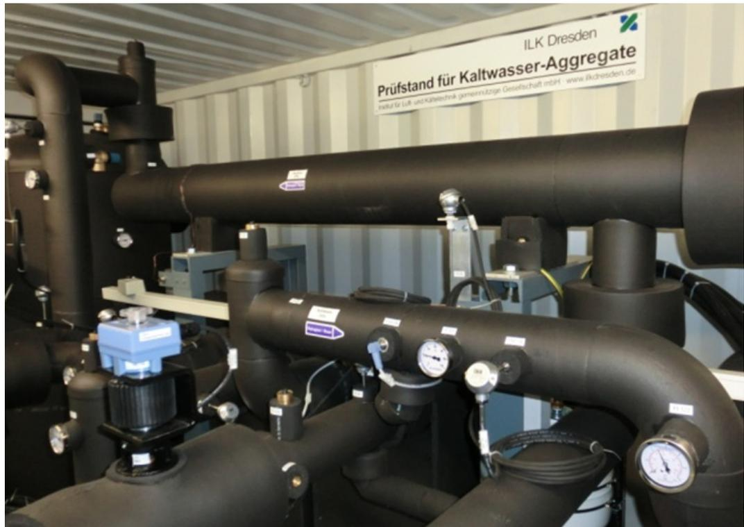
Bild 3: Lastsimulationsanlage für KWS
