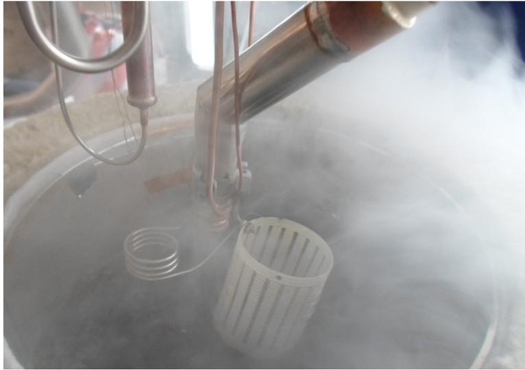
Bild 3: Test eines  $^3\text{He}$ -Kühlkreises in flüssigem Stickstoff
