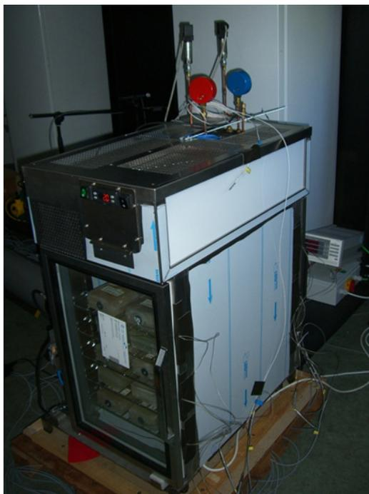
Bild 2: Leistungstest mit Prüfpaketen
