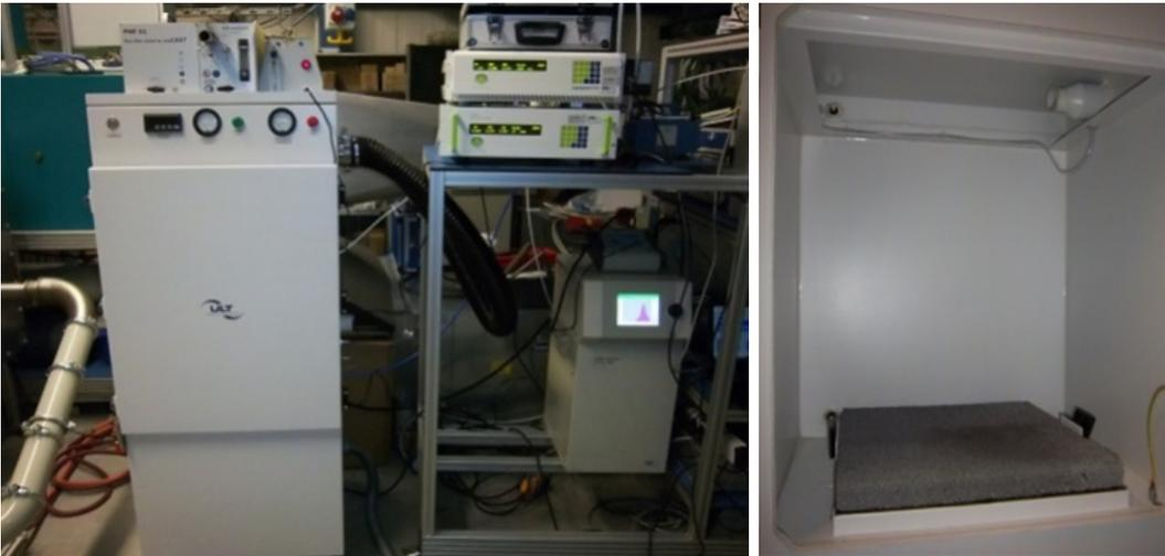
Bild 1: Versuchskammer zur Aerosol- und Gasphasen-Untersuchung
