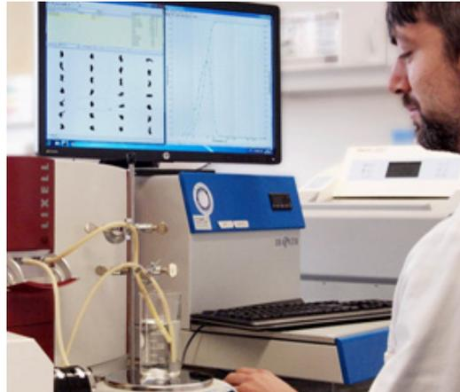
Bild 2: Erfassung der Form- und Größenverteilung des Faserkollektivs einer Kollagensuspension mit einem modernen optischen Bildanalysesystem.
