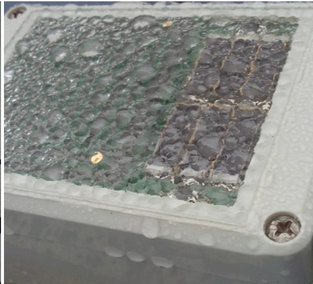
Bild 2: Sensor im Freifeldtest
