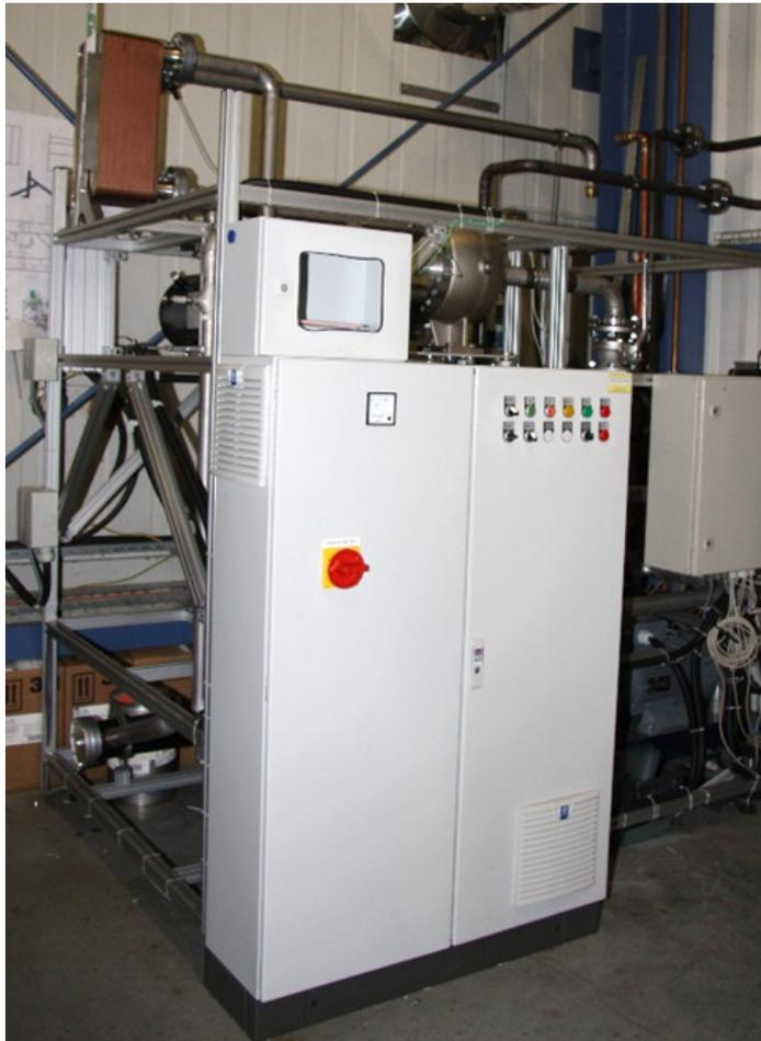
Bild 2: ORC – Modul der Anlage
