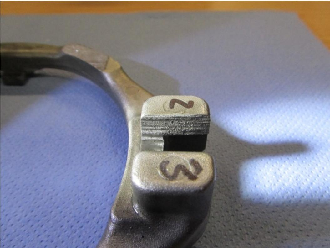
Bild 1: Verschleiß am Oldhamring eines Scrollverdichters
