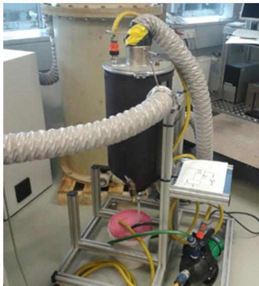
Bild 1: Messtechnik für die Partikelanalyse und Gaswäscher für die Partikelabscheidung
