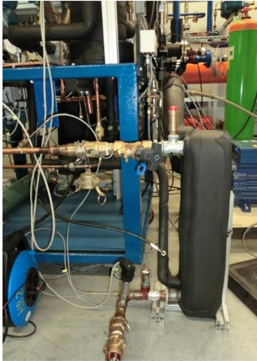
Bild 2: Test Plattenwärmeübertrager
