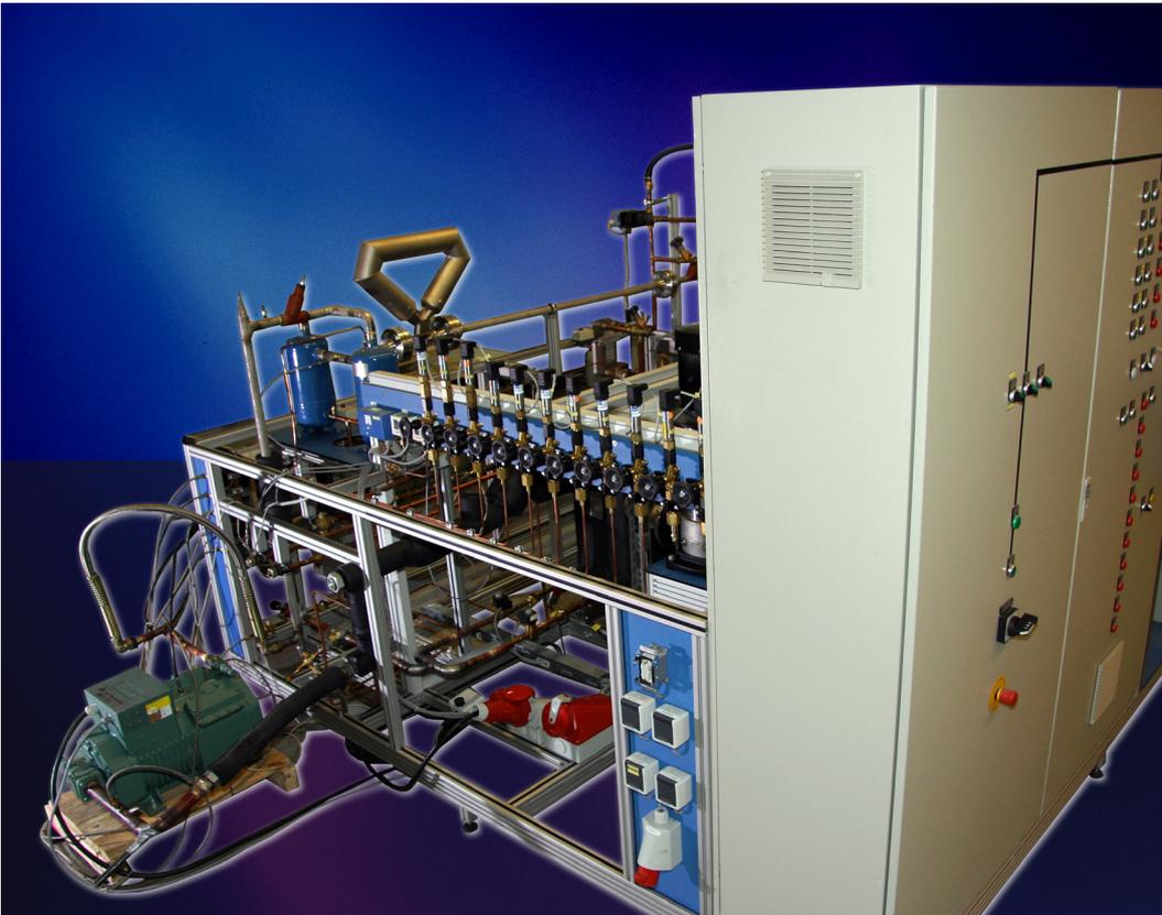
Bild 1: Verdichterleistungsprüfstand
