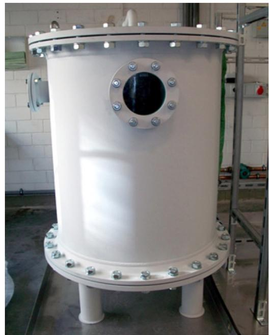
Bild 2: Speicherbehälter für 29 kWh mit ca. 410 kg PE-UHMW-PCM
