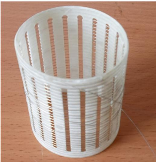
Bild 1: Impedanz für einen  $^3\text{He}$ -Kühler, auf einem GFK-Träger montiert
