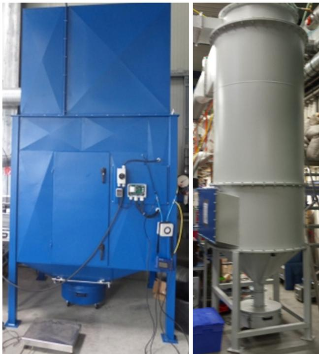
*Bild 2: Abscheidermodelle für die unterschiedlichen Einsatzfälle*
