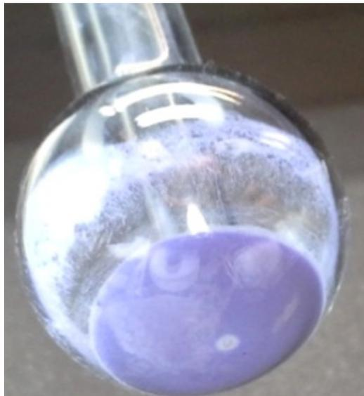
Bild 2:  $[(\text{Cu}(\text{Me-4py-trz-ia})_2)]$  nach Evakuierung bei 100 °C.
