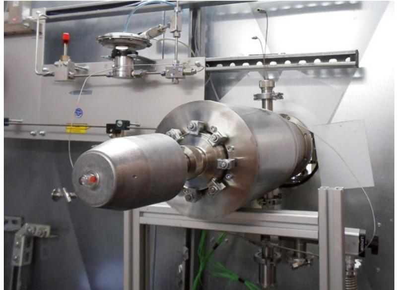
Abbildung 2: Versuchsaufbau für Ventiltests im ILK-Wasserstofflabor
