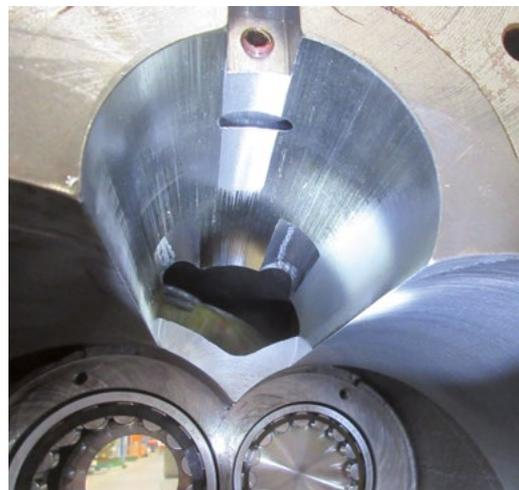
Bild 1: Schaden an einem Schraubenverdichter
