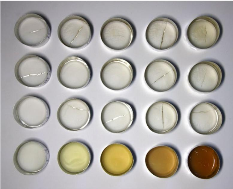
Abbildung 1: HD-PE nach Auslagerungsversuch (Reihe 1 - 3 mit, Reihe 4 ohne Antioxidans)
