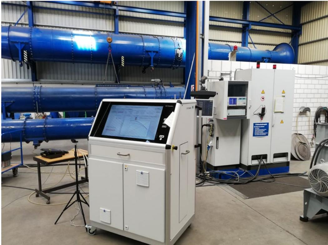
Bild 3: Mess- und Berechnungsmodul für die Leistungsmessung von Prozessluftventilatoren eines Industriekunden
