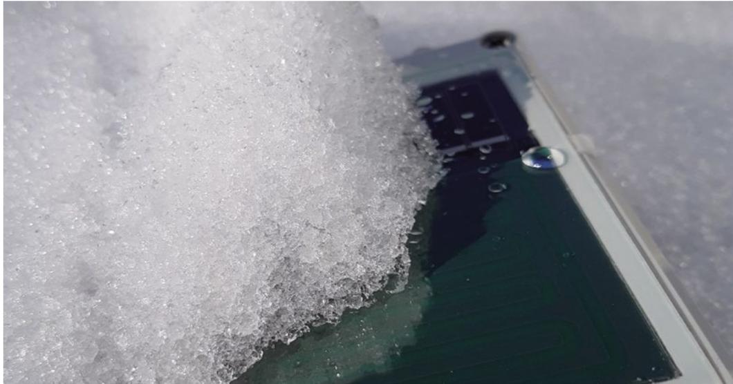
Abbildung 1: Sensor mit teilweiser Schneebedeckung
