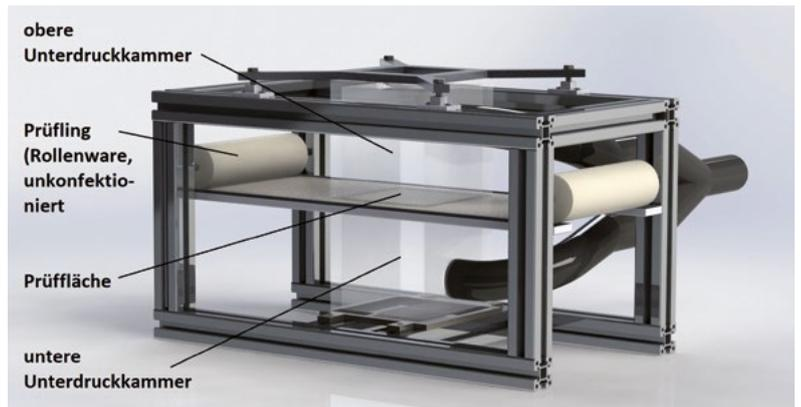
Bild 2: Strömungstechnische Untersuchung des Beladers
