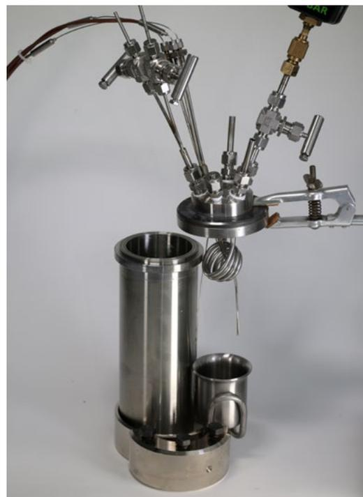
Abbildung 1: Extraktionsapparatur zur dynamischen Alterung von Werkstoffen
