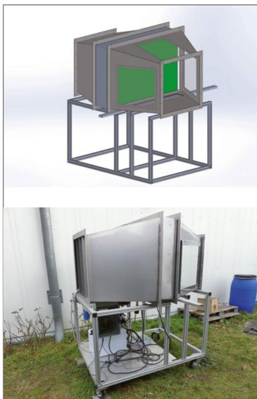
Abbildung 2: Konstruktion und Aufbau des Versuchsstand-Prototyps
