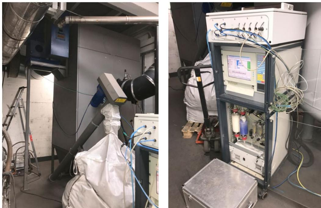
Bild 3: Messaufbau an einem Filter mit FTIR-Spektrometer
