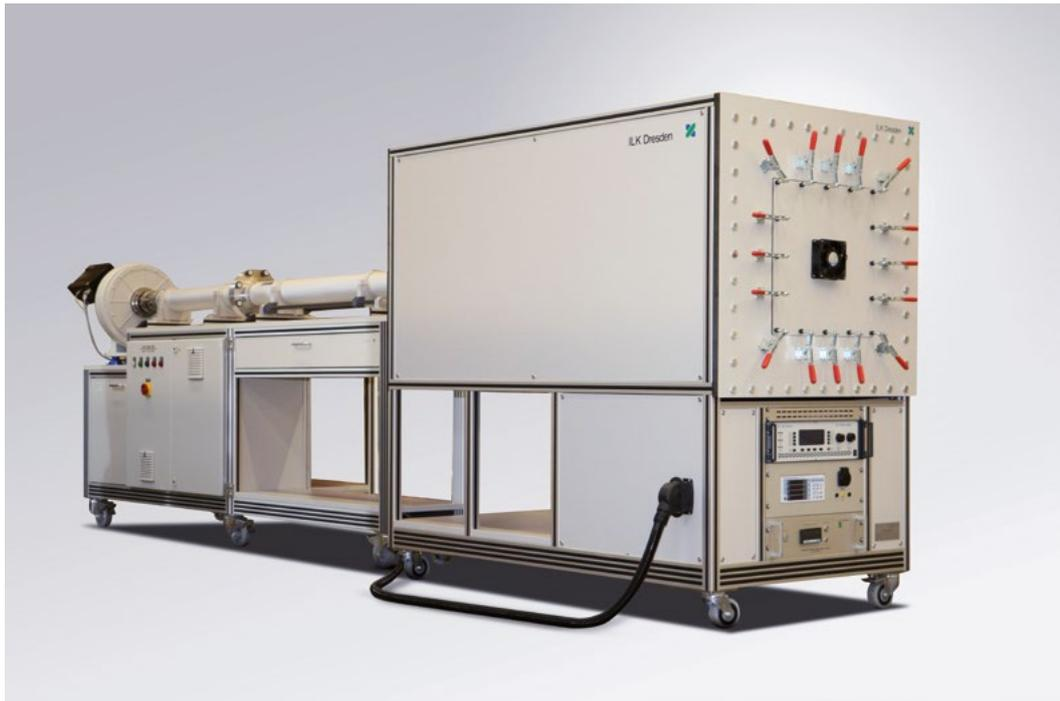
Bild 2: Entwickelter Volumenstromprüfstand für hochpräzise Kennlinienmessungen
