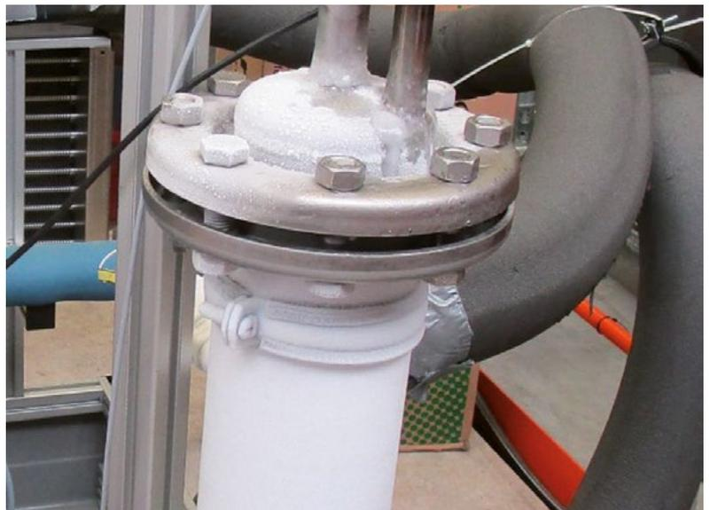
Bild 2: Das Foto zeigt den Prototyp des neu entwickelten Sublimations-Wärmeübertragers im Betriebszustand. Die starke Bereifung des Wärmeübertragers resultiert aus der noch fehlenden Wärmeisolation während des Testbetriebes.
