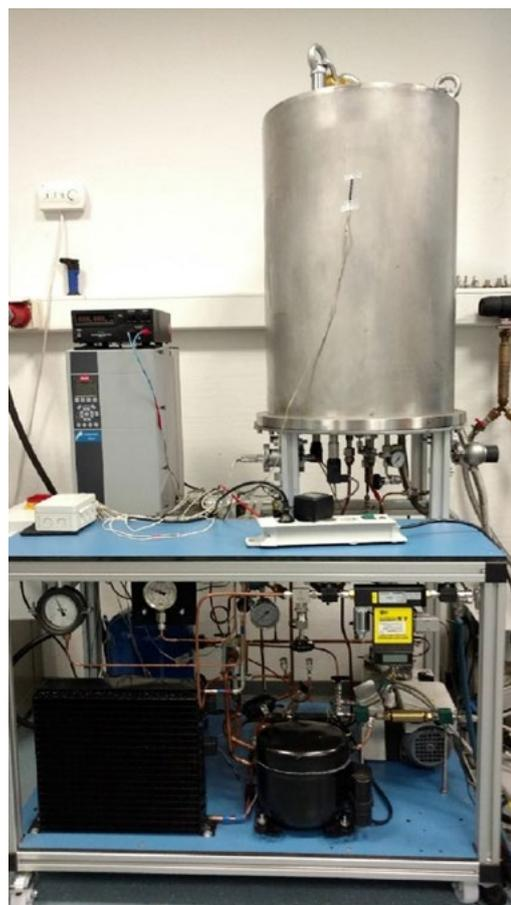
Abbildung 1: Bestehendes Labormodell eines Kältegemischkühlers, mit welchem eine Temperatur von 90 bis 100 K erzielt wurde
