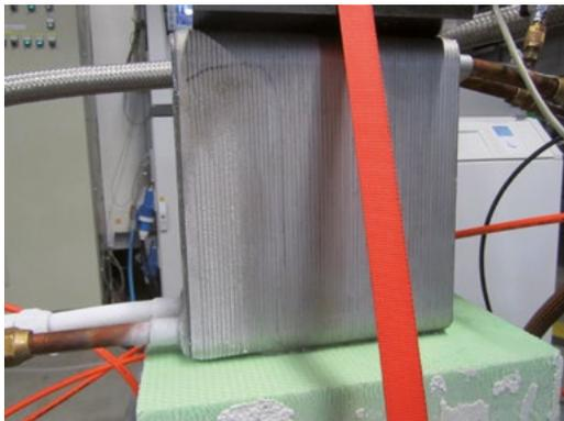
Bild 3: Plattenwärmeübertrager einer Ammoniakkälteanlage in einer Brauerei
