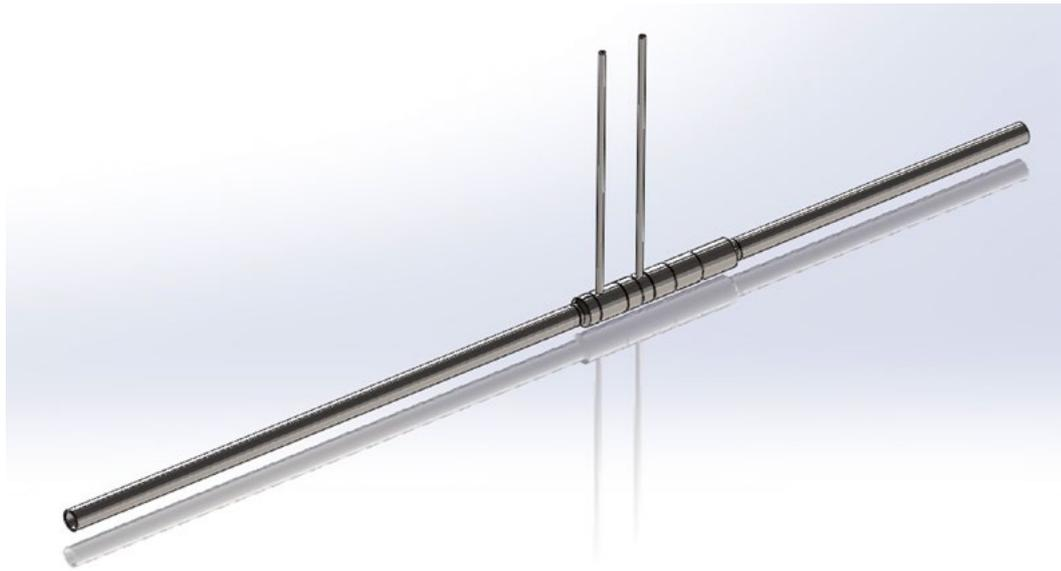
Abbildung 1: Konstruktionsmodell eines Venturirohrs, welches zum Test (mit Helium im Zweiphasengebiet) im Versuchstand eingebaut ist.
