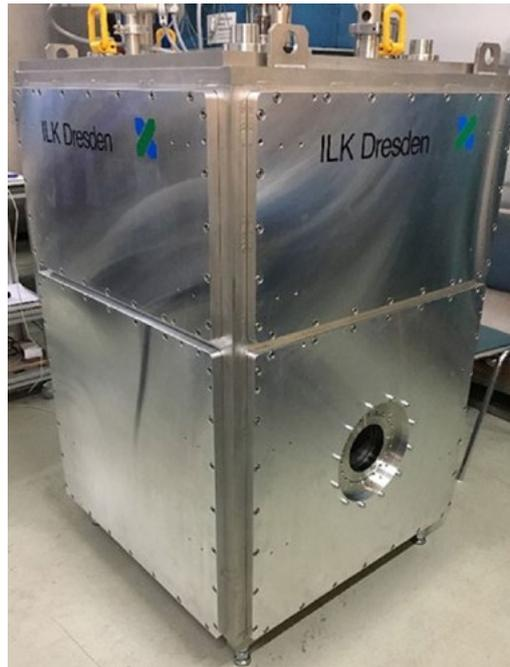
Abbildung 3: CCC-Kryostat im Helium-Testfeld des ILK Dresden
