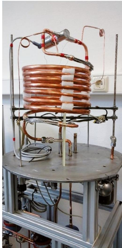
Abbildung 1: Spiralwärmetauscher des Labormodells des Kältemittelgemisch-Kühlers
