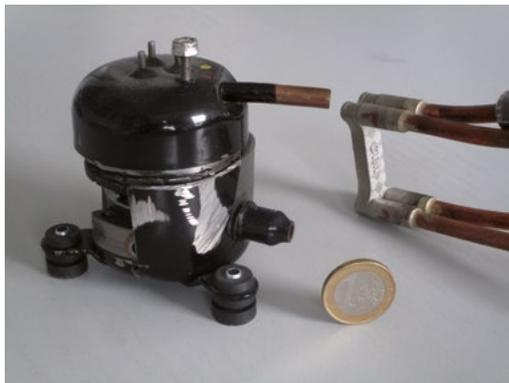
Abbildung 1: Kleinstverdichter und Mikro-Wärmeübertrager im Größenvergleich
