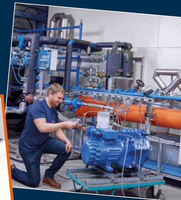
Komponentenuntersuchungen: Verdichterleistungsmessung nach DIN EN 13771-1
