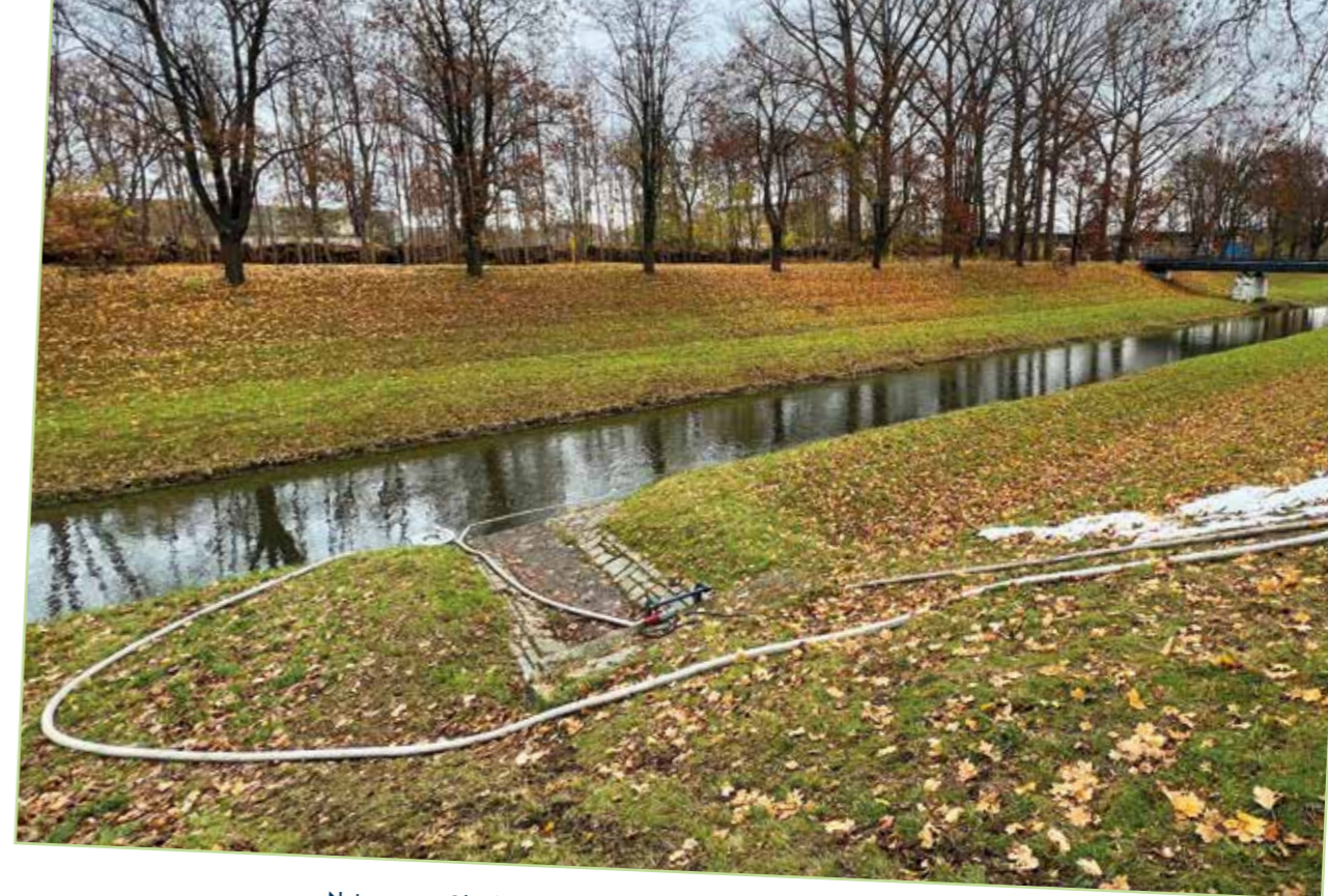
Nutzung von Oberflächengewässern als Wärmequelle – hier im Bild die Mandau bei einem Kurzzeitfunktionstest
