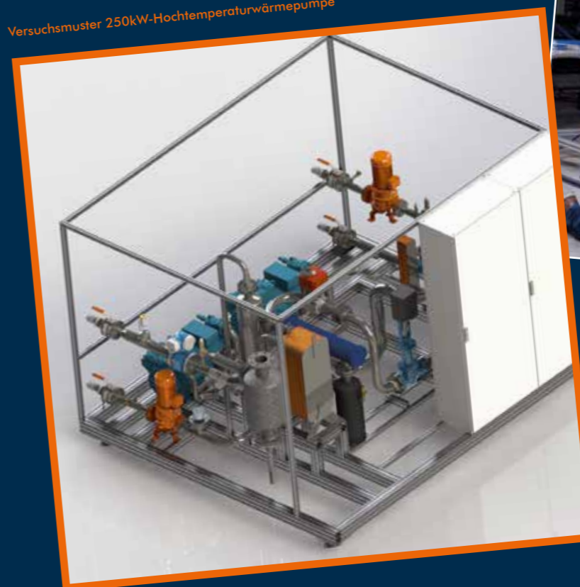
Komponentenuntersuchungen: Verdichterleistungsmessung nach DIN EN 13771-1
