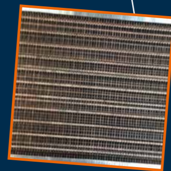
Draufsicht auf einen offenen asymmetrischen Plattenwärmeübertrager mit 140 Platten
