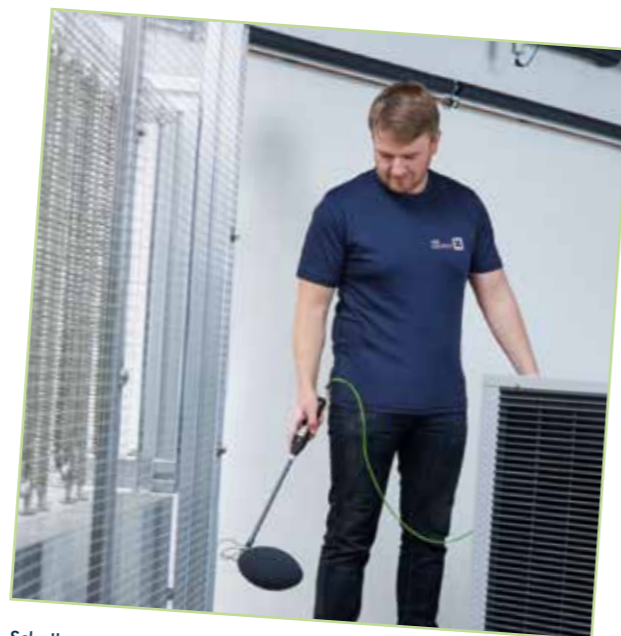
Schallmessungen an einem Wärmepumpen-Außengerät
