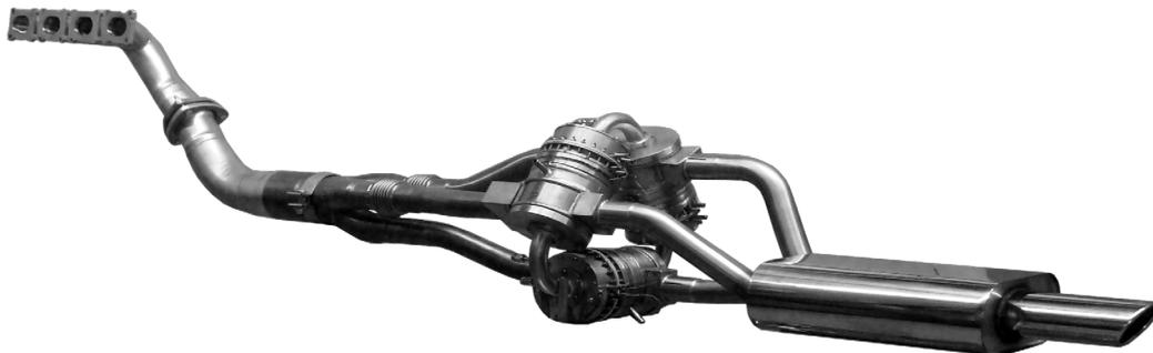
Abbildung 3: Integration der Wärmekraftmaschine in den Abgasstrang
