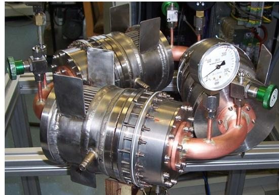
Abbildung 2: Wärmekraftmaschine, montiert
