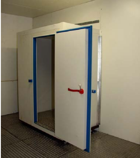
Bild 2.1 Mehrzonen-Klimazelle des Prüflabors Wärmepumpen (PLWP)
