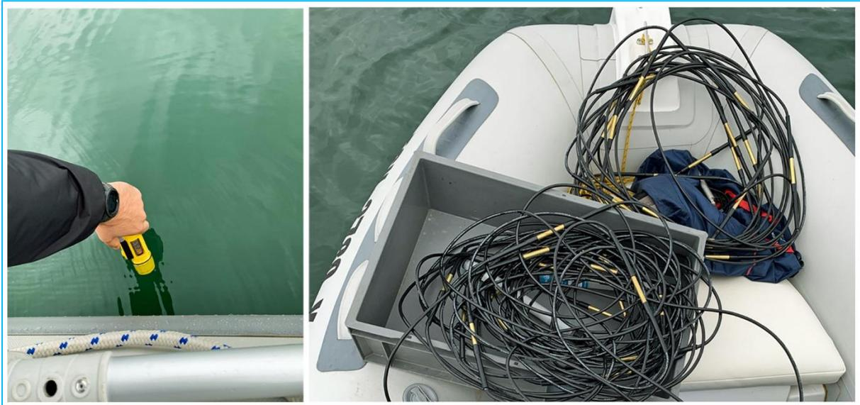
**Abbildung 37: Wassertiefenmessung (HONDEX PS-7), Vorbereitung der Temperaturmessketten**
