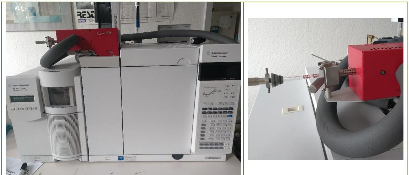
Abbildung 2-15: Gaschromatograph Agilent 7890 mit massensensitivem Detektor MSD 5975C mit integrierter thermischer Desorptionseinheit und Kaltaufgabesystem
